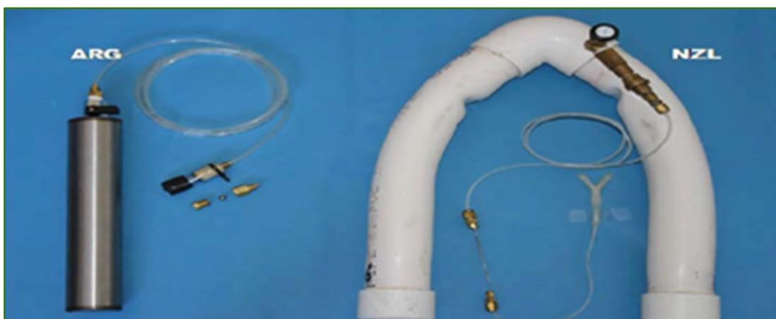
**Figura 3.** Desarrollo de prototipos mejorados para la medición de emisiones de metano con la técnica de SF<sub>6</sub>.
