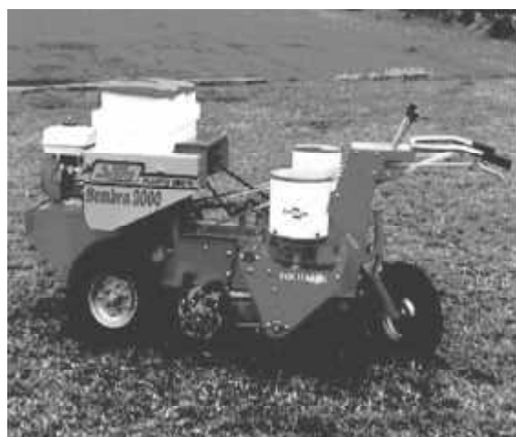
Figura 2.31. Sembradora autopropulsada, para siembra directa, modelo SEMBRA 2000, con dos líneas de siembra.
