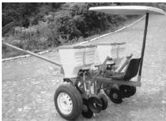
Figura 2.30. Sembradora de tracción animal, para siembra directa, modelo Fitarelli, con dos líneas de siembra.
