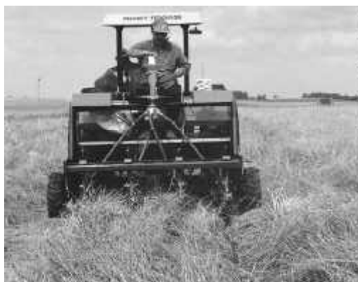
Figura 2.36. Sembradora para siembra directa de parcelas experimentales - SEMINA I - versión múltiple
