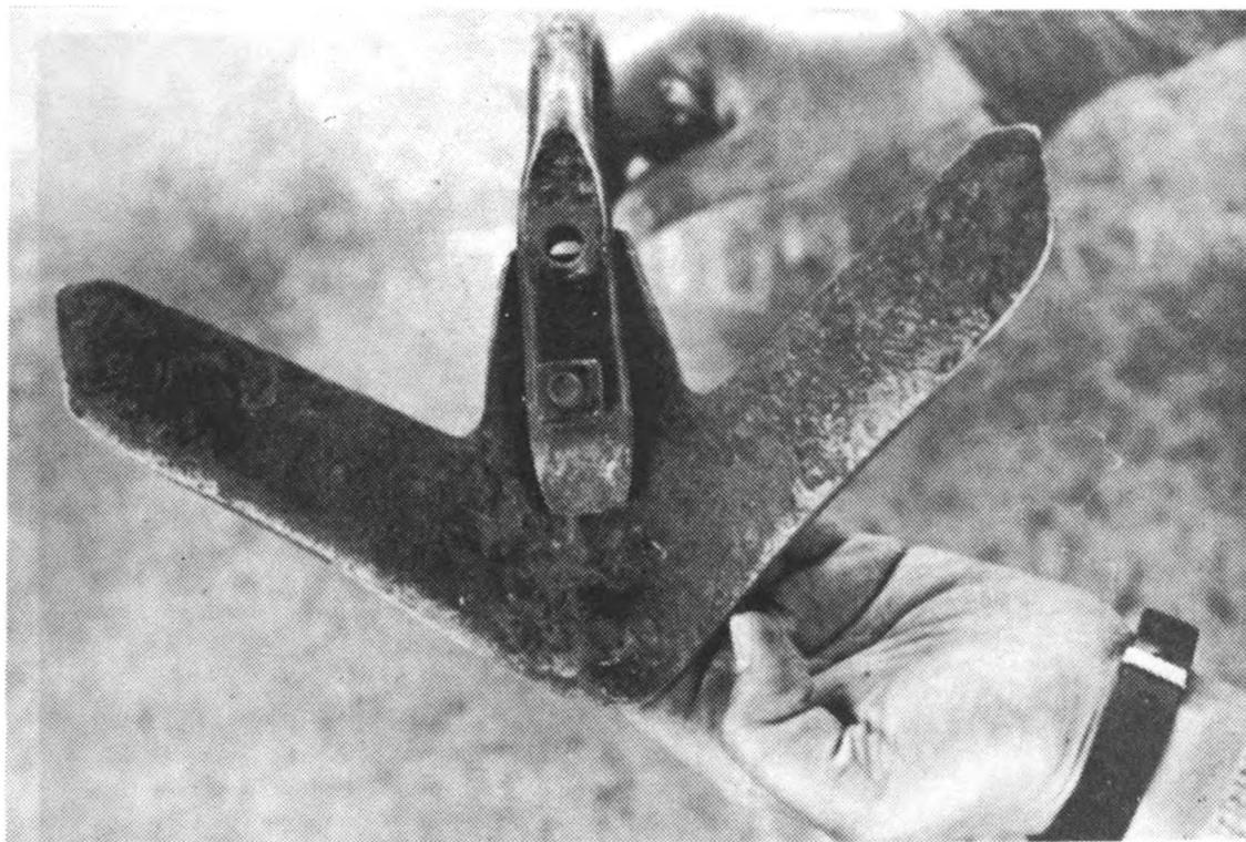
Figura 31. Ubicación de un escardillo en el orificio inferior del vástago.
