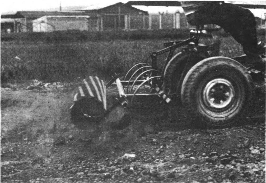
**Figura 17. Vibrocultor ICAT-INIA. Trabajo combinado de escarificadores con un rodillo tipo jaula.**
