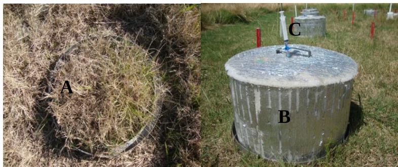
Figura 5. Diseño de las cámaras para muestreo de gases.
