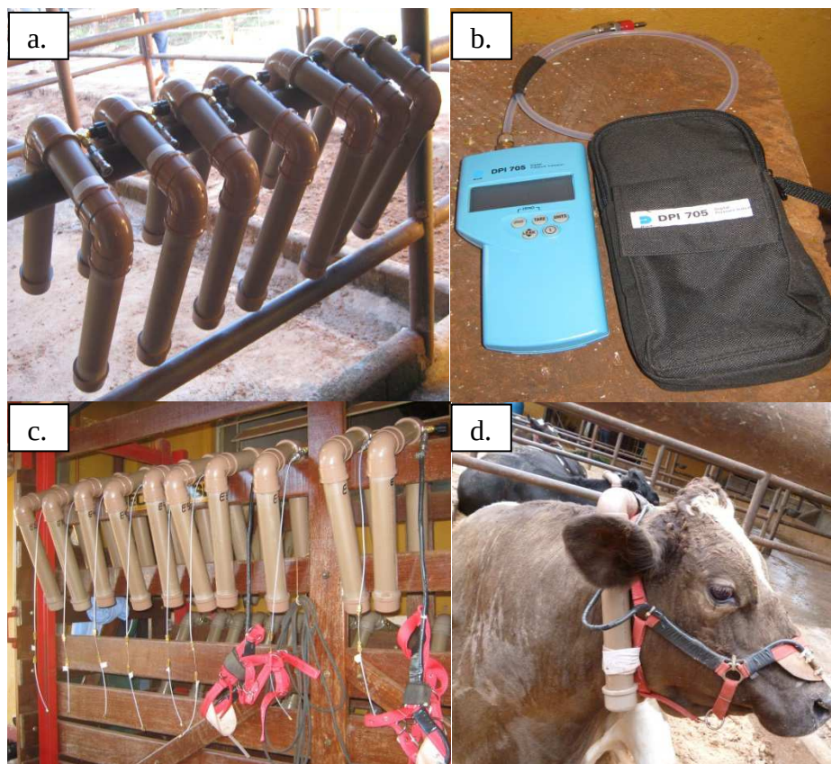
Figura 7 - Técnica do gás traçador \text{SF}_6 para a mensuração de metano
