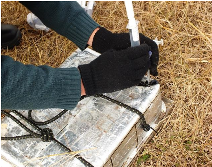
Figura 1.8. Recolección de aire de la cámara estática cerrada por medio de jeringas.
