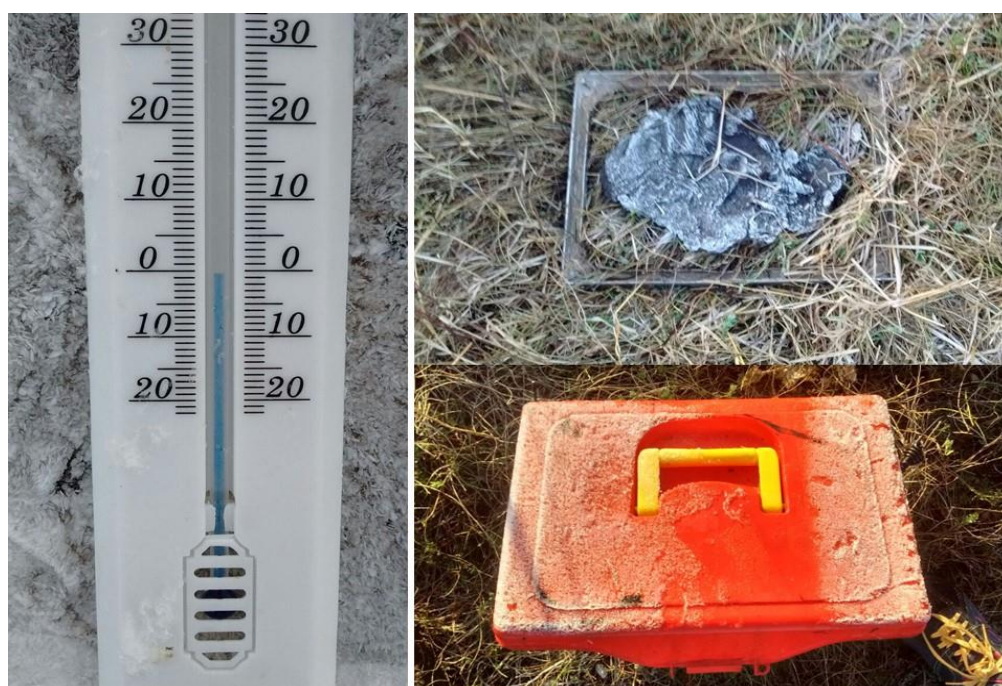
Figura 1.5. Termómetro, cámara de tratamiento de heces y caja de muestreo utilizados durante un muestreo en condiciones de heladas durante el período invernal.
