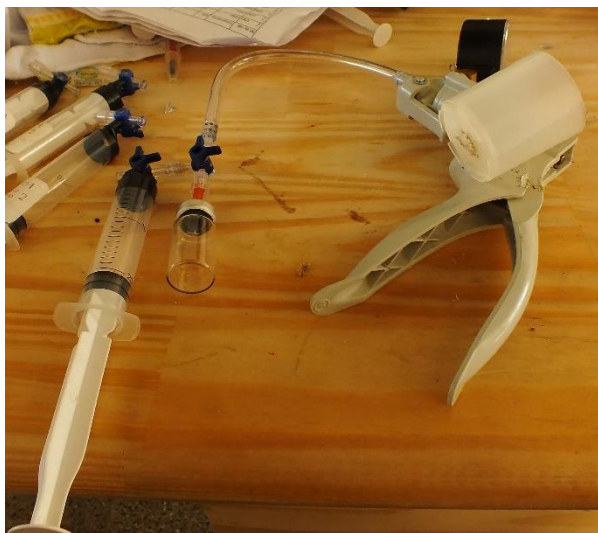
Figura 1.9. Sistema de inyección de la muestra desde las jeringas hacia los viales a través de una bomba de vacío manual.
