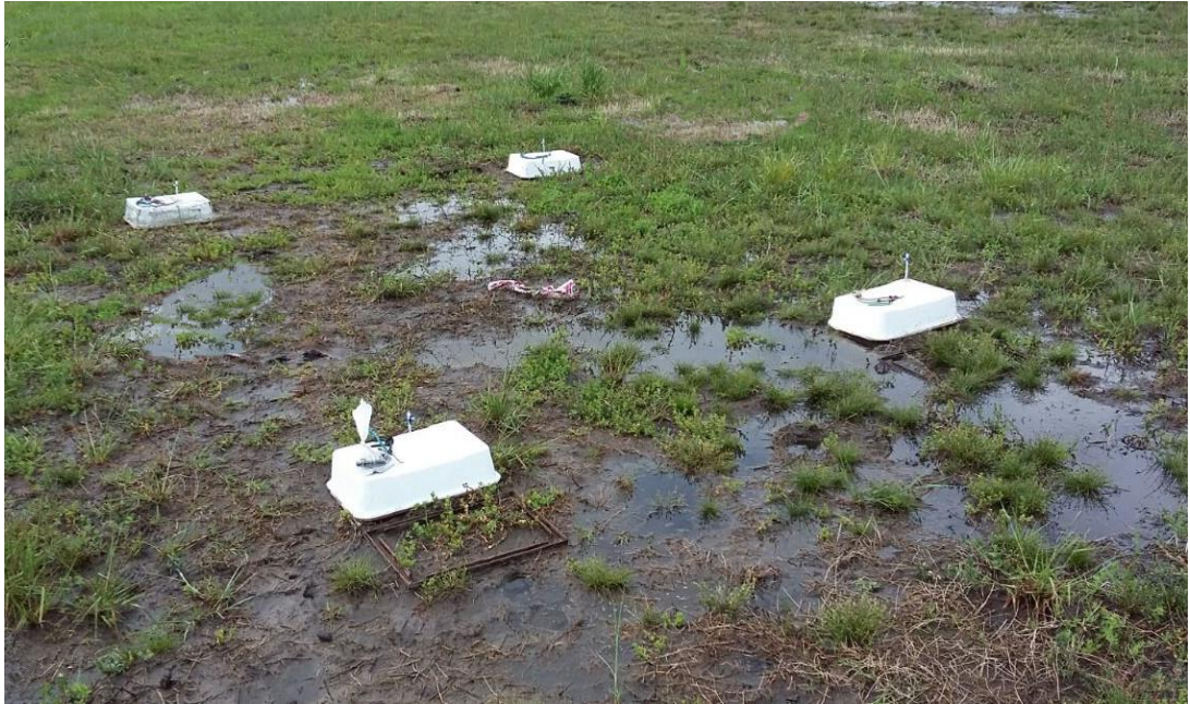
Figura 1.7. Materiales preparados para el inicio de la colecta de gases en suelos anegados. En la imagen se pueden ver los marcos de metal clavados en el suelo y las tapas que conformarán las cámaras cerradas estáticas.
