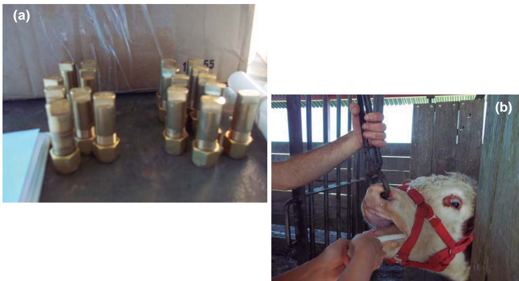
Figura 9. (a) Tubos de permeación rellenos de SF 6 ; (b) El tubo de permeación es suministrado al animal utilizando lanza-bolo.
