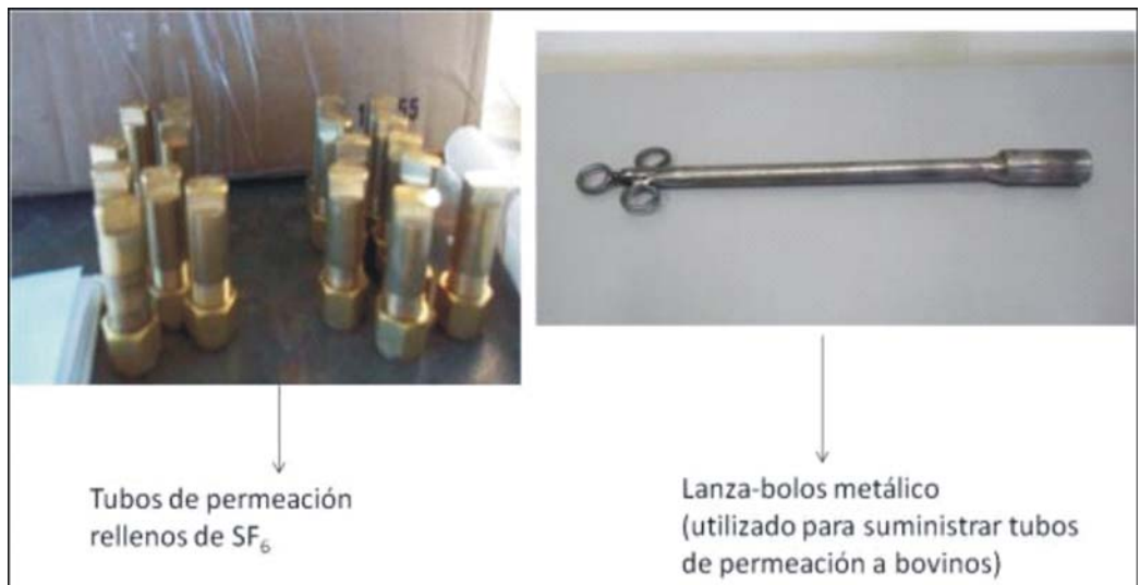
Figura 4. Tubos de permeación y lanza bolos metálico.
