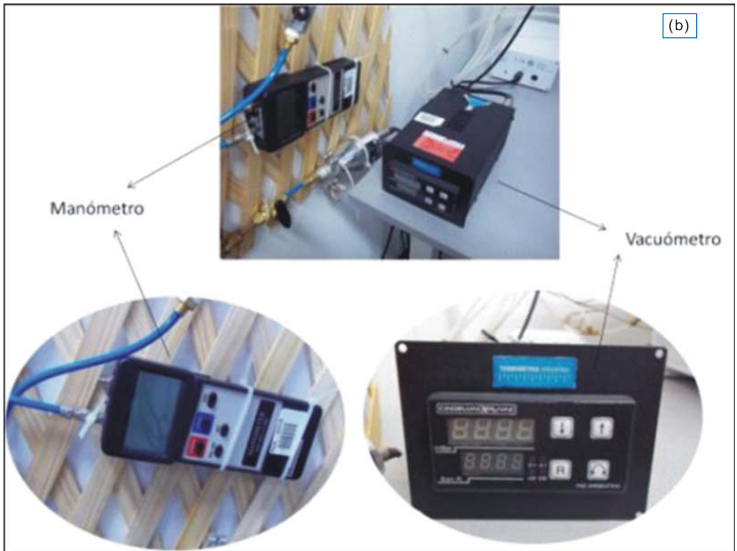
Figura 6. (a) detalles del Retículo de vacío; (b) detalles de Manómetro y Vacuómetro
