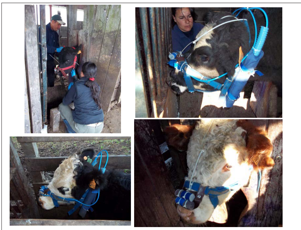
Figura 10. Detalles de la colocación del recipiente colector en su porta-tubos y restrictores de flujo.
