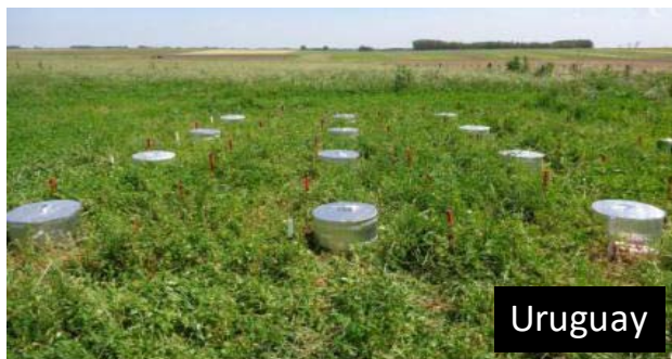
Figura 6. Detalles de los experimentos de medición de las emisiones de N_2O llevadas adelante por los cinco países del consorcio. Todos los países utilizaron la metodología manual de las cámaras estáticas de flujo cerrado.
