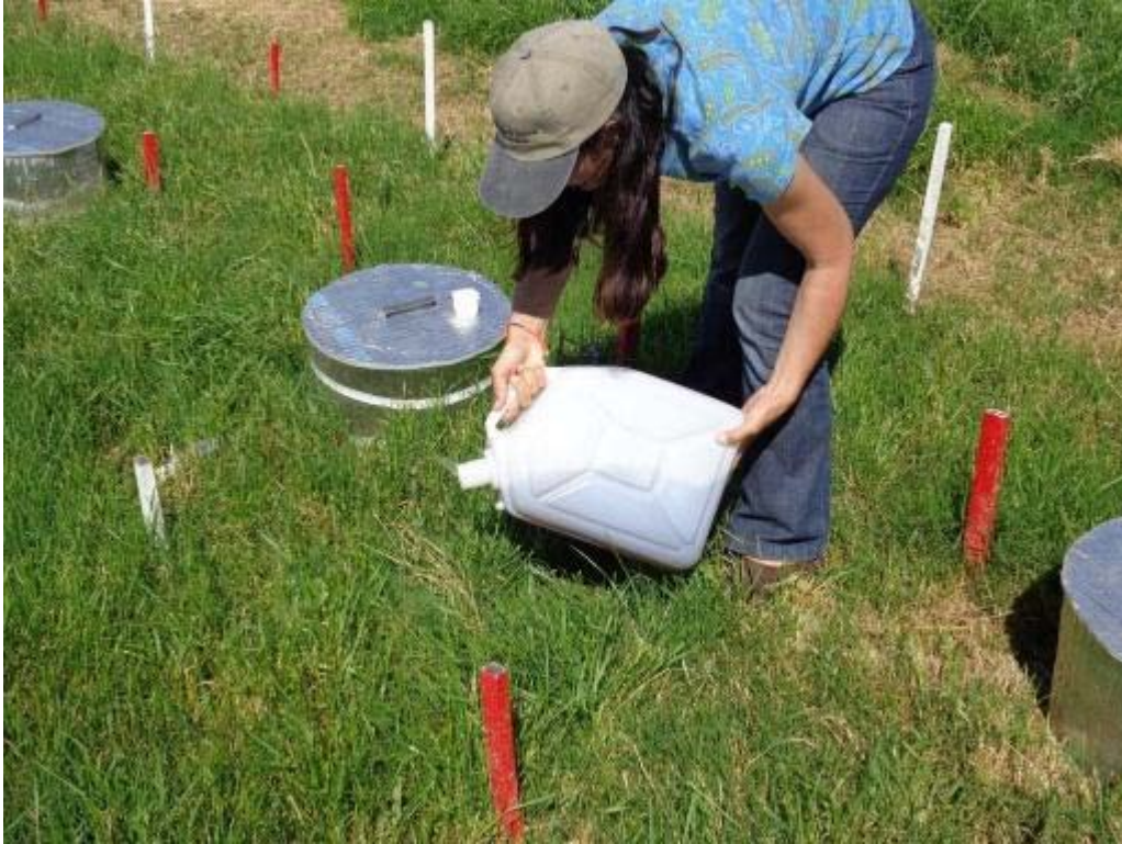
Figura 7. Aplicación de orina bovina en las parcelas y cámaras de los experimentos de N 2 O.
