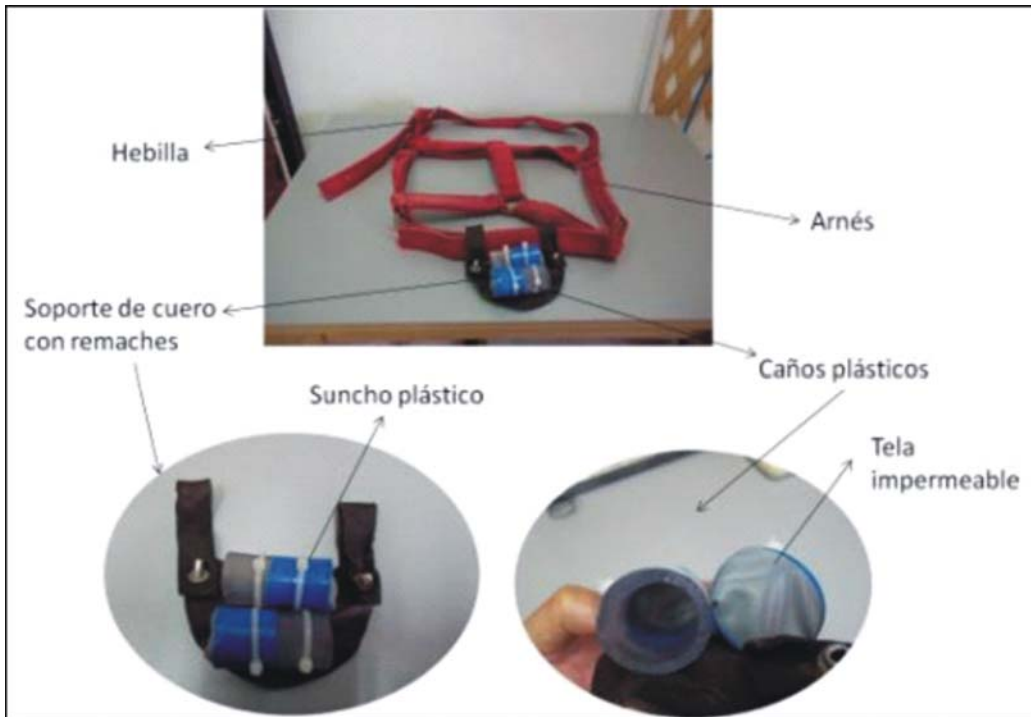
Figura 1. Detalles del arnés, soporte de cuero y caños plásticos.
