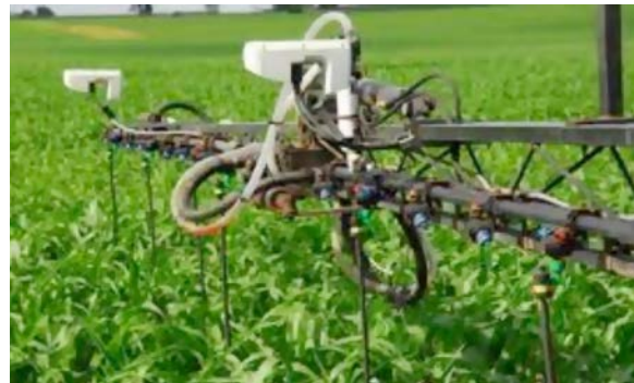
Figura 8. Una serie de unidades de sensor montadas sobre cada fila en un aplicador de fertilizante puede ser usado para estimar las necesidades de N en la marcha y guiar el controlador del aplicador para ajustar la dosis de la aplicación de side-dress fertilizante nitrógeno en tiempo real. Foto: Corn & Soybean Digest
