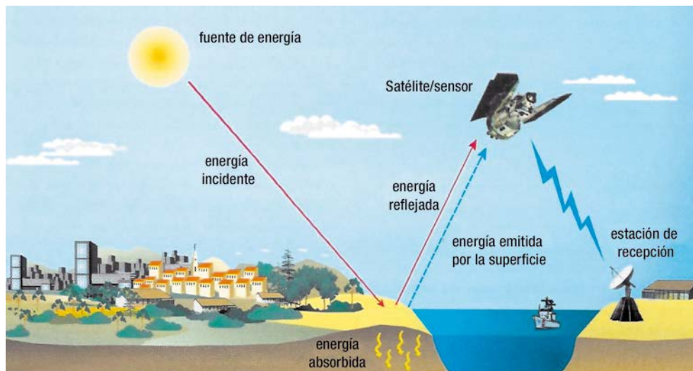
Figura 1. Elementos de la etapa de adquisición de datos por teledetección (o adquisición remota). Fuente: Florenzano (2011)
