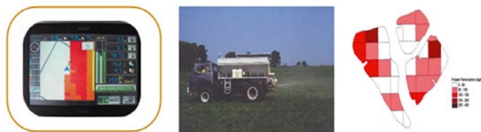
Figura 3. Monitor de aplicación variable de agroquímicos
