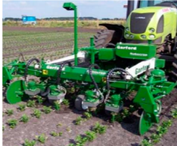
Figura 17. Robocrop, tractor robotizado de la empresa Tillett and Hague Technology Ltd. , para eliminar la maleza de forma mecánica sin dañar el cultivo útil
