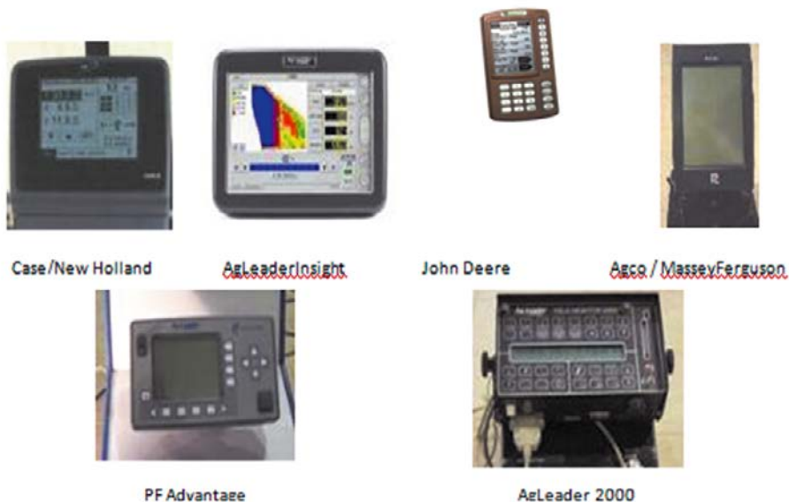
Figura 1: Monitores de rendimiento más difundidos
